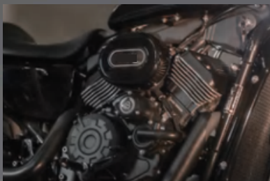
800cc V twin-cylinder refrigerado por agua.
