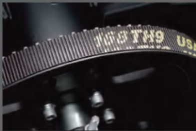
Transmisión por correa. Estable, e ciento y muy silenciosa
