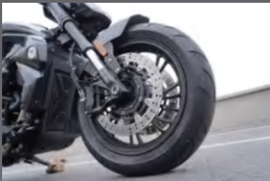
Frenos delanteros y traseros con ABS de doble canal con caliper flotante.
