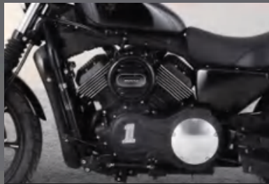
800cc V twin-cylinder refrigerado por agua. Motor de gran torque.
