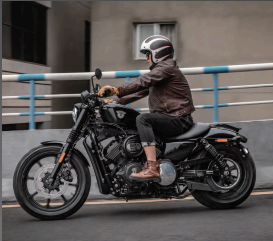
Diseño Americano tradicional. Chasis de doble cuna que incrementa la rigidez. Calipers de doble pistón con ABS de doble canal.
