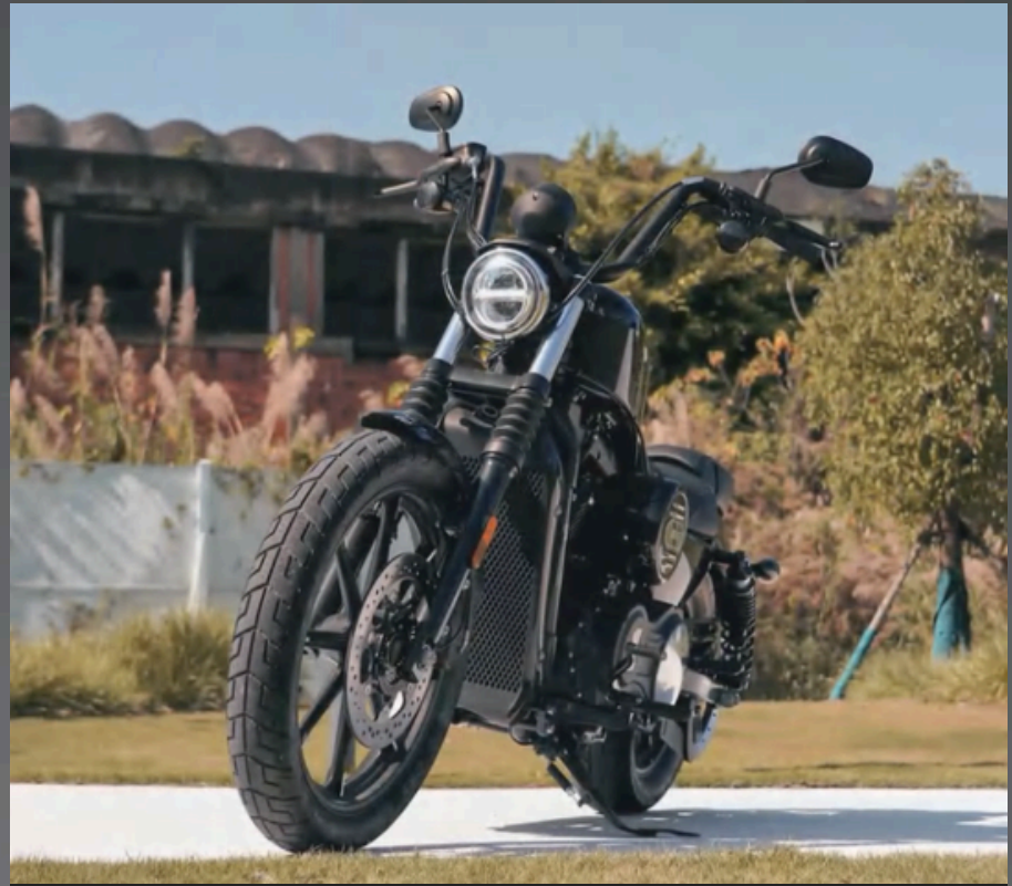
Diseño Americano tradicional. Chasis de doble cuna que incrementa la rigidez. Calipers de doble pistón con ABS de doble canal.
